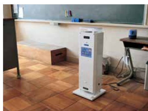
教室に設置した紫外線でウイルスを除去する空気清浄機
